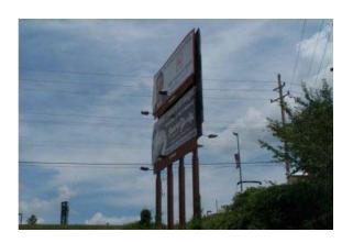
STEEL MULTI-MAST DOUBLE FACE (STACKED DISPLAYS)
